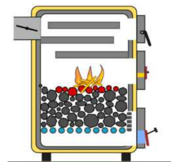
4. Przełóż żar z popielnika na wierzch nowego zasypu. Dołóż nieco rozpałki wedle potrzeb. Nawet gdy żar przestał świecić, wciąż jest na tyle gorący, że bardzo ułatwi rozpalenie.
